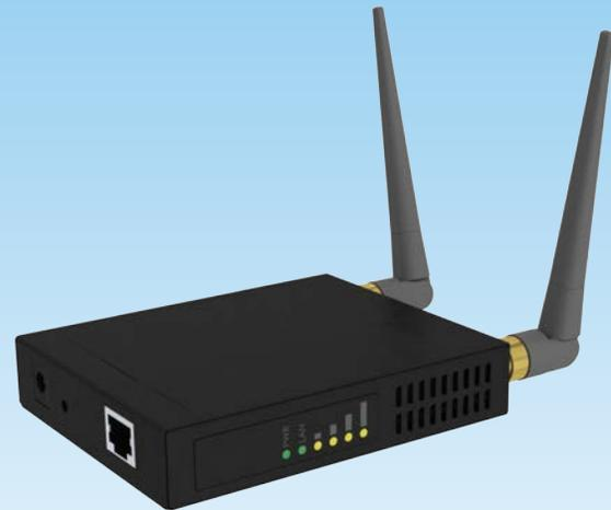
APC 2Mi - это компактная, но мощная и производительная 2.4 ГГц точка доступа, предназначенная для решения задач в помещениях и на улице (но не предназначена для прямого попадания воды). Имеет мощный MIMO радиомодуль (30 дБм), поддерживающий стандарты 802.11n, но совместимый и со старыми устройствами по протоколу 802.11b/g. Устройство управляется многофункциональной операционной системой, которая
